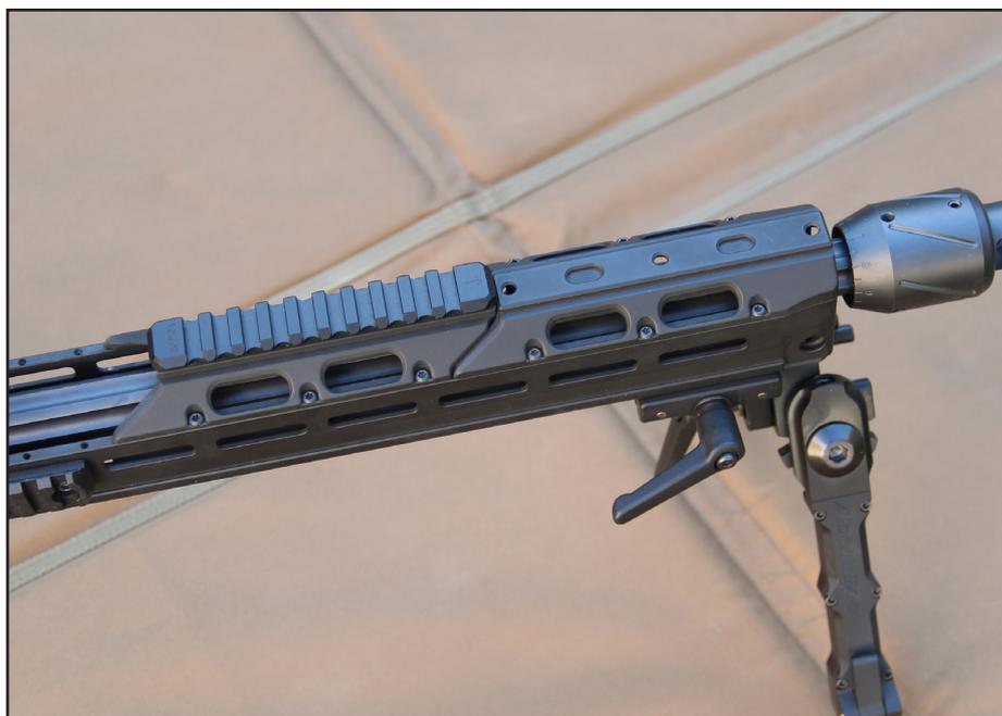
serrer au couple l'ensemble des pièces, y compris l'action sur la section centrale. La relative largeur interne du garde main permet d'intégrer un canon de fort diamètre et il est possible d'équilibrer parfaitement l'arme avec les poids internes, mais il faudra vérifier que ceux-ci n'entrent pas en contact avec le canon. Enfin, la crosse et les gardes mains sont équipés d'attaches de sangle QD.
