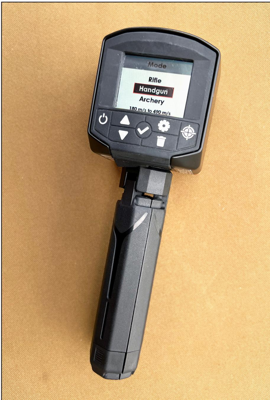
dans les menus. A sa droite, nous avons deux autres boutons, celui du haut représenté par une roue dentée permet d'accéder au menu des paramètres de l'appareil, celui du bas permet d'effacer la prise de vitesse que l'on souhaite ou une série complète de tirs. Enfin, le bouton de droite permet d'armer ou de désarmer le LX. Cette option est intéressante car elle permet de ne pas solliciter le radar quand on ne l'utilise pas et joue sur l'économie de la batterie.
