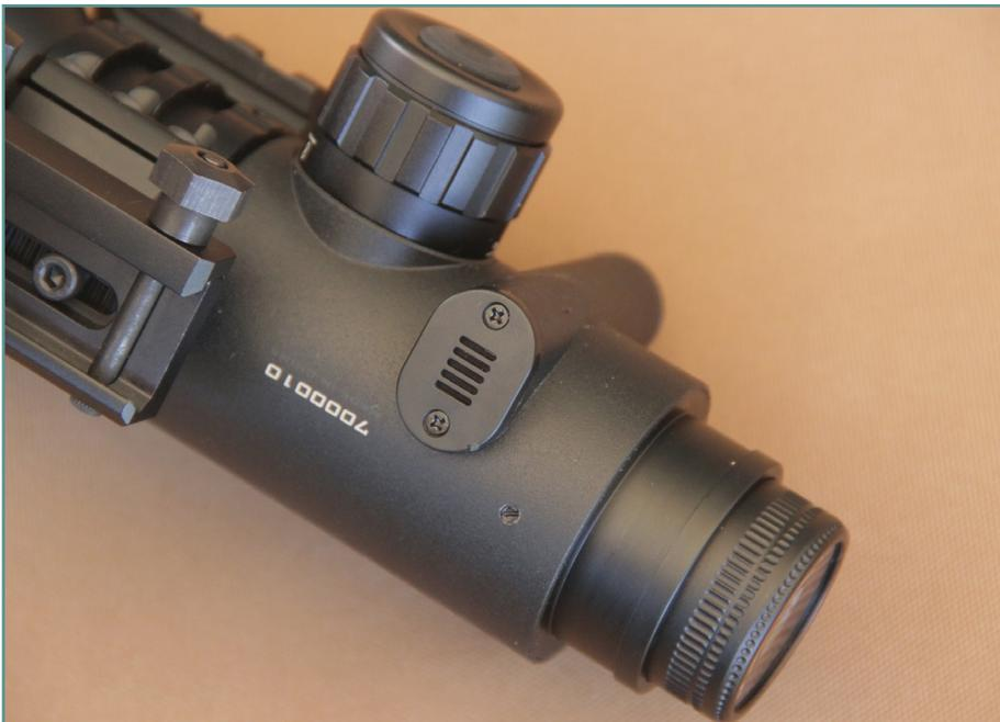
Ne cherchez pas les tourelles de hausse et de dérive, l'HYPR-7 n'est pas équipé de ce type de dispositif de réglage. Par contre, la tourelle d'élévation laisse place au bouton d'alimentation du réticule numérique. A l'arrière du bouton d'alimentation, nous avons une molette permettant de naviguer dans les différents menus de la lunette, mais aussi de configurer les éléments permettant de calculer une solution de tir via le logiciel balistique.
