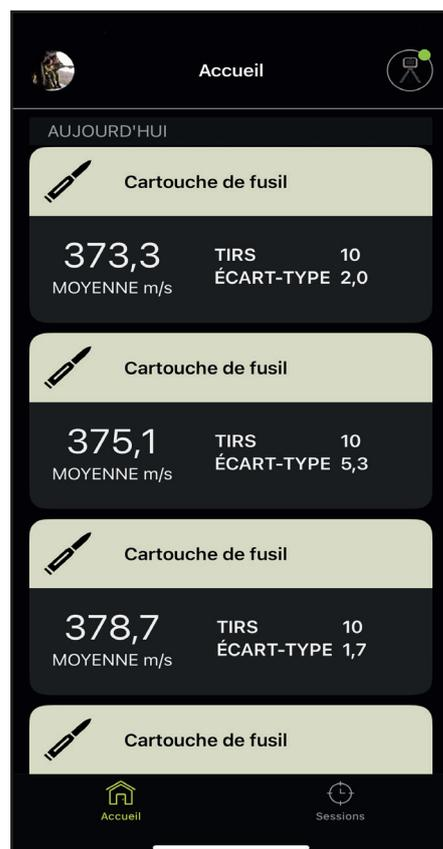
installé, il suffit de commencer à tirer pour avoir une mesure. La mesure s'affiche sur l'écran entre 1 et 3 secondes après chaque tir, on peut apercevoir sur l'écran le temps qui s'écoule sous la forme d'une roue.
