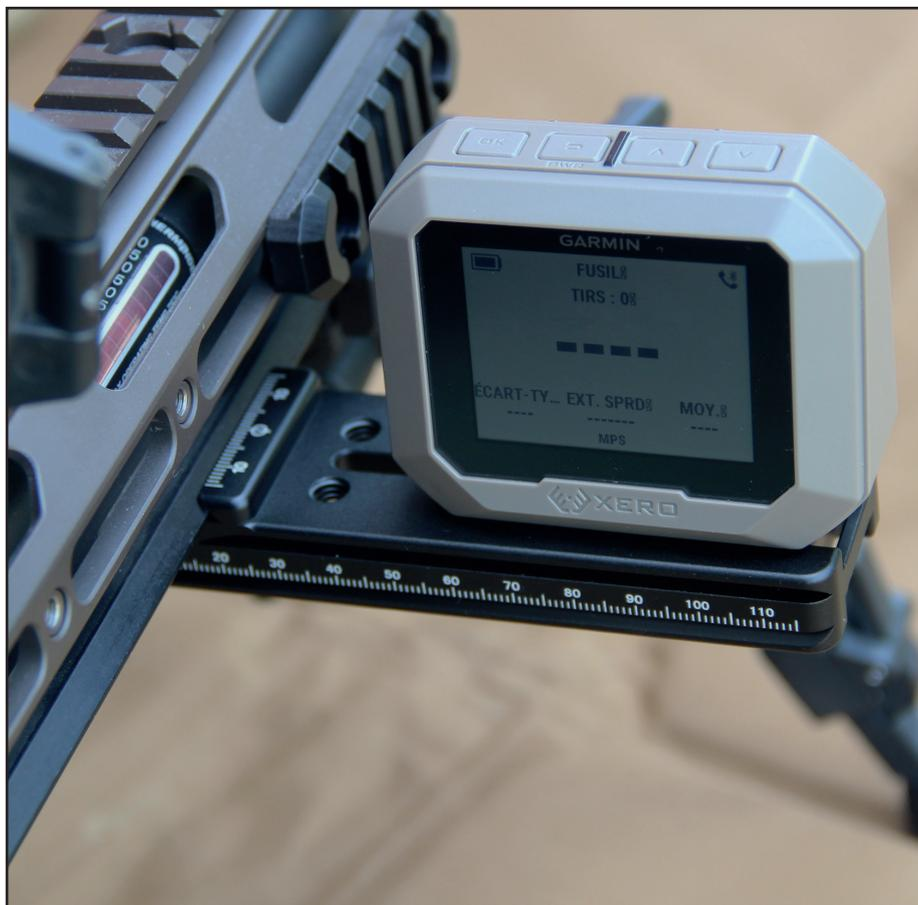
Le rétroéclairage est correct mais demande de le positionner sur le niveau le plus haut pour obtenir une visibilité optimale des infos inscrites sur l'écran. Le couplage avec l'application permet de sauvegarder les sessions de tir et de pouvoir les exporter. Nous regrettons l'absence de monitoring permettant de lire les mesures de vitesse sur l'application au fur et à mesure qu'elles s'inscrivent sur l'écran du XERO C1 PRO. Le XERO C1 PRO est conçu pour
