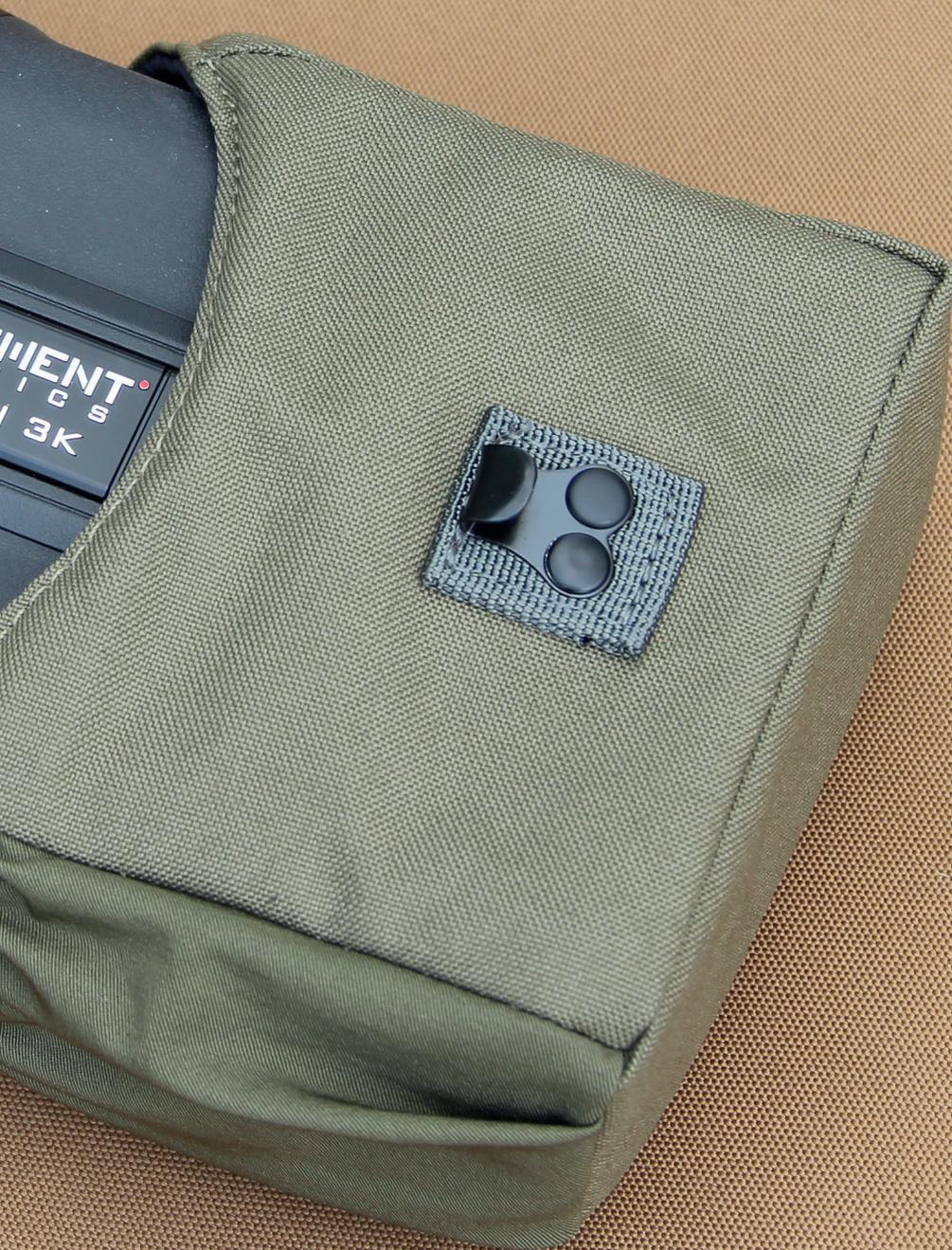
L'étui du télémètre offre une protection toute relative, le rabat se ferme à l'aide d'un crochet et un passant. Les boutons permettant de le faire fonctionner se trouvent sur le dessus du télémètre. Un filetage au standard photo est placé sous l'appareil ; il permettra de fixer l'appareil à un trépied afin de pouvoir télémétrer des cibles précisément et à très longue distance.
