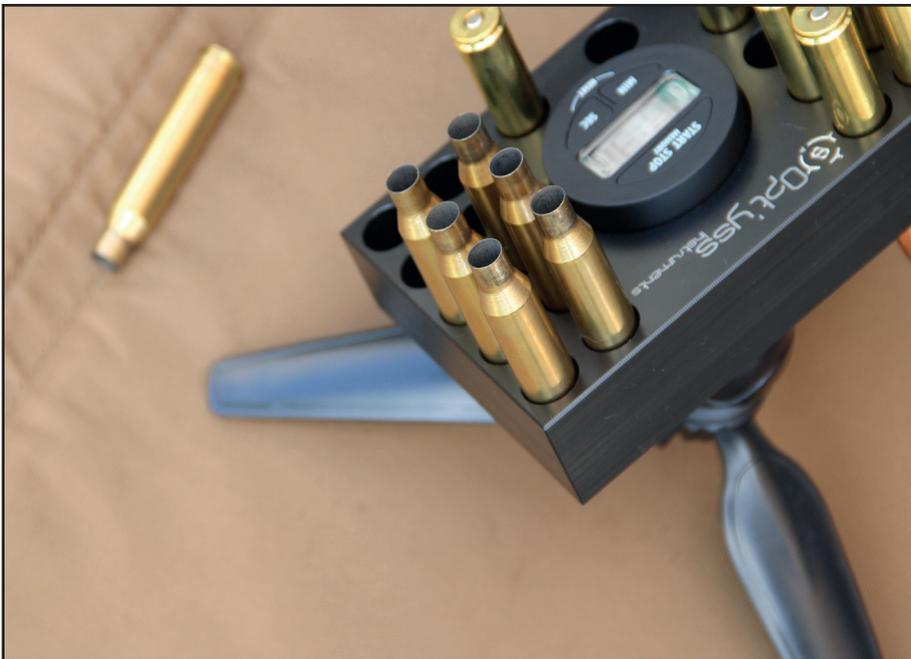
Au centre du support, un emplacement est prévu pour un chronographe. Il intègre trois vis BTR qui vont permettre au Chronographe équipé d'un aimant de s'y loger. Le chronographe est correctement positionné dans le support et son verrouillage est optimal. Opt'yss Instruments a choisi un chronographe TFA qui permet, soit d'actionner un chronomètre, soit un compte à rebours. Si vous appuyez sur le bouton start, le chrono se déclenche, si vous rappuyez, il s'arrête.
