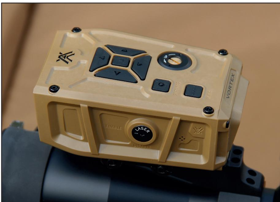
nous trouvons des boutons en forme de flèche permettant de naviguer de haut en bas pour les boutons verticaux et de droite à gauche pour les boutons horizontaux.
