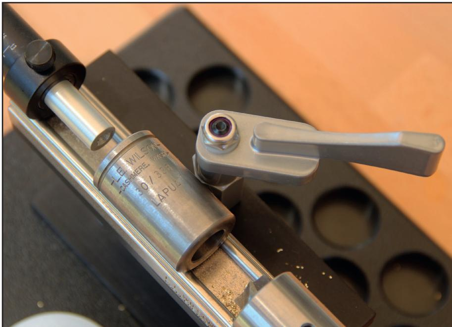
profondeur de coupe, il suffit de déplacer le support de la lame, celui-ci est fixé par une vis BTR sur le bâti. La lame de coupe peut se désolidariser de la manivelle afin, soit de le changer, ou pourquoi pas tenter de le réaffûter.
