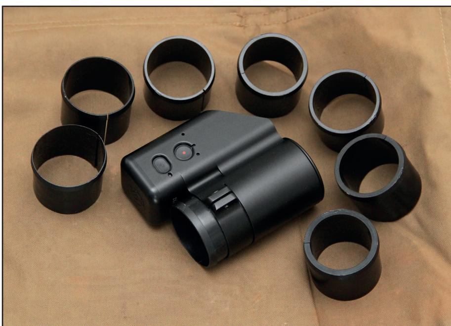
Reste à régler la netteté de l'image avec la molette située sur le dessus de la caméra, le réglage s'effectue avec l'outil qui permet de tourner plus facilement la molette, mais il faudra avant tout coupler la caméra avec son smartphone pour visualiser à l'écran le réglage de la netteté.
