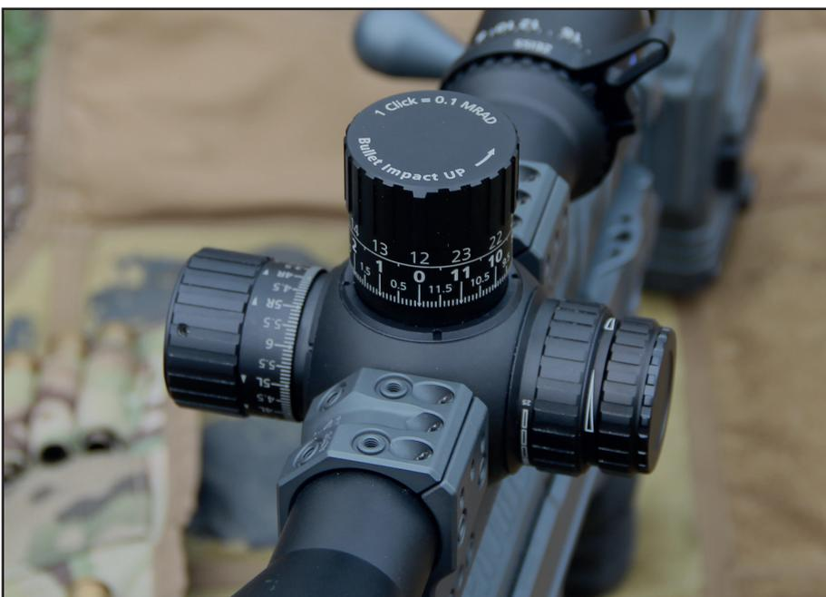
fixer la LRP sur de nombreux montages du marché. Aucun détrompeur n'est visible sur la tourelle, ce sont des graduations inscrites sur le corps de la tourelle qui permettent au tireur de visualiser sur quelle plage de la tourelle il se trouve. Nous avons rapidement constaté que ce système de graduation était très précis.
