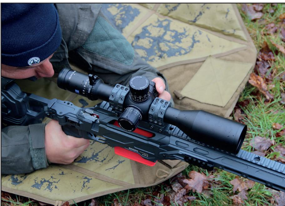
Nous avons pris une contre visée inférieure à 8 Mrad sur la partie basse du réticule, le reste, nous l'avons intégré sur la tourelle d'élévation pour obtenir la totalité de la correction. Nous avons été frappés par l'absence de déformation de la cible même sur les parties les plus proches du bord de la lentille.
