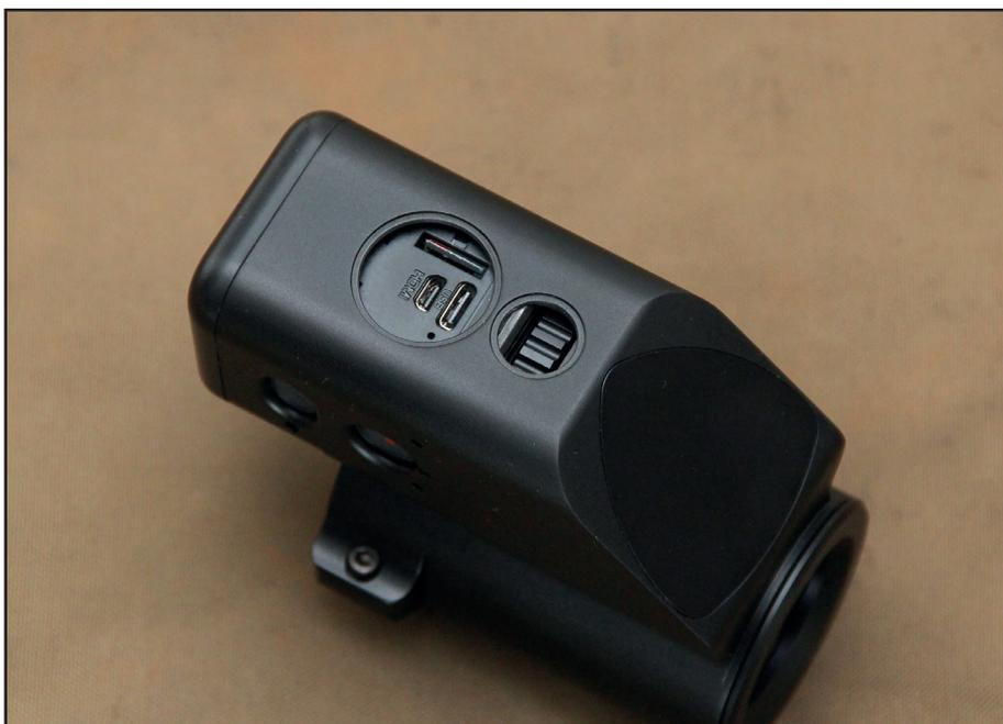
Le logement avant contient le logement de la carte Micro HD, le port USB-C pour la mise en charge de la caméra, mais aussi un port micro HDMI permettant de connecter la vidéo aux tablettes, Smartphones ainsi que d'autres appareils mobiles. Le logement arrière intègre une molette qui va permettre de régler la netteté de l'image au travers de la lunette via la caméra.
