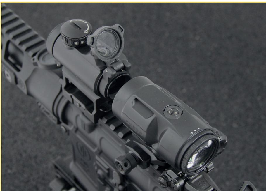
Le montage peut recevoir deux cales (spacer) permettant d'augmenter la hauteur du magnifier par rapport à l'optique positionnée devant, ou permettre le passage du magnifier au-dessus de l'élément de visée de secours arrière. D'un autre côté, il est si petit qu'il ne gênera pas les visées mécaniques montées sur l'arme.
