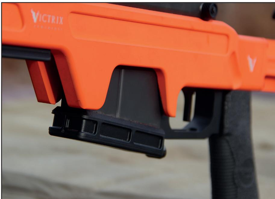
Le chargeur amovible construit en métal est propriétaire à l'arme, il s'agit du série T de la marque. Il pèse 172 g. Il peut contenir jusqu'à 10 cartouches de .308, et il est équipé d'un talon de chargeur relativement épais. Son insertion dans le châssis est particulière, il faut lors de l'introduction dans le puits de chargeur incliner le chargeur vers l'avant et ensuite relever l'arrière pour le verrouiller, un peu comme pour un chargeur d'AK47.
