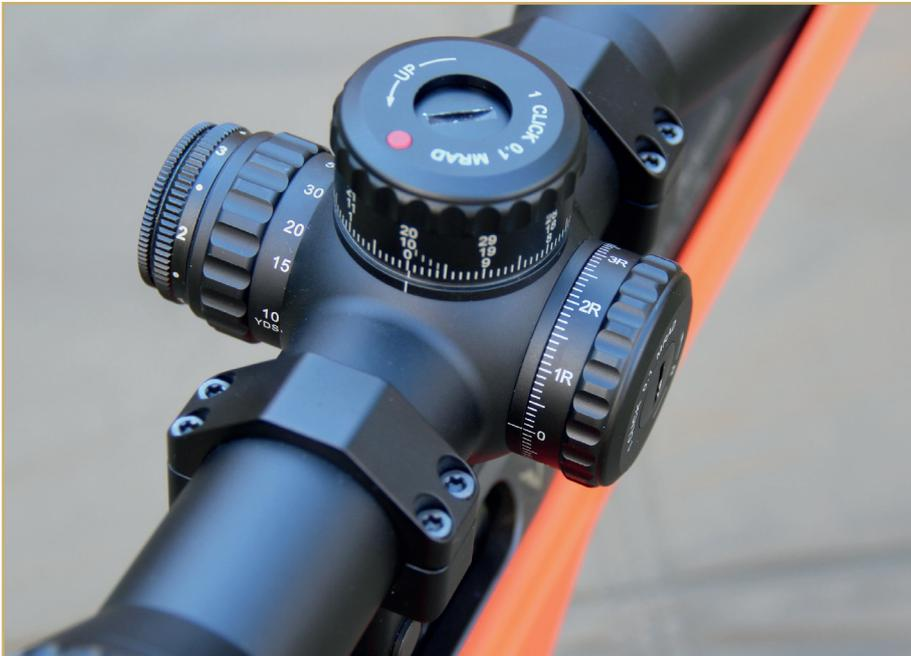
Les tambours de la BOREALIS 3-18x50 sont en dixièmes de millièmes soit : un clic = 0.1 Mrad ; c'est, de plus, inscrit sur le dessus du tambour d'élévation et de dérive. Le sens de rotation des tourelles est anti-horaire ou plus communément appelé CCW (counterclockwise). Les chiffres et les marquages sont fins et petits, certaines personnes peuvent éprouver des difficultés à lire la correction affichée.
