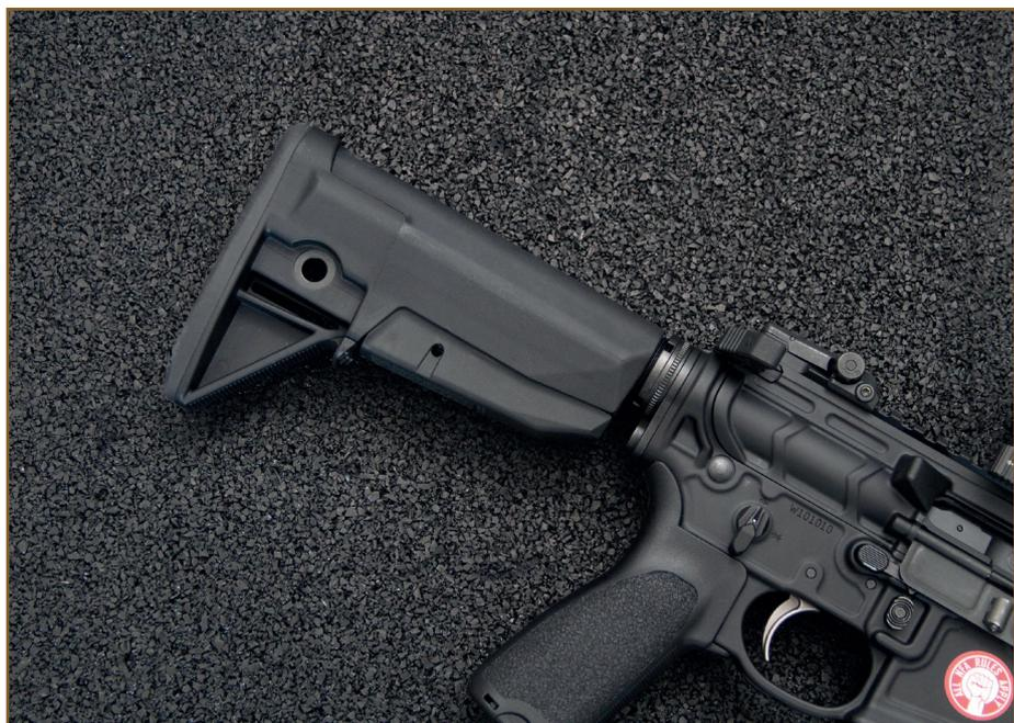
2,675 kg. Le Mk107 est chamberé en .223 Wylde. Ce chamberage a la particularité de permettre l'utilisation de cartouches .223 Remington, mais aussi de 5,56x45 NATO en toute sécurité, tout en garantissant une excellente précision quel que soit le calibre utilisé.
