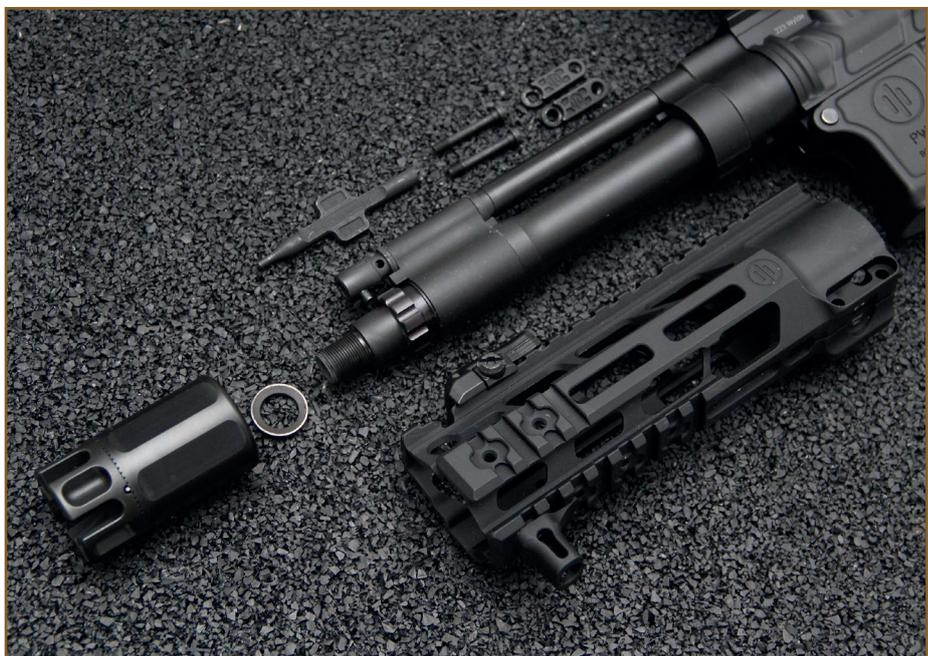
Comme nous l'exprimions en début d'article, le fonctionnement de l'emprunt des gaz est assuré par un piston directement monté au-dessus du canon. Ce système emprunte son architecture au piston de l'AK47, nous avons donc un piston à course longue qui est solidaire du transporteur de culasse.
