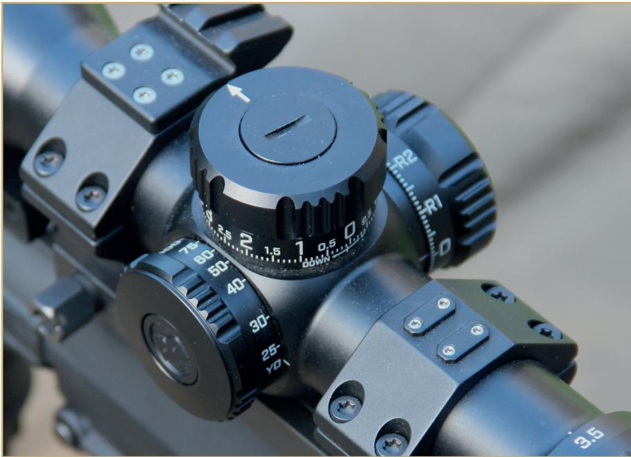
équipée d'un levier afin de faciliter son utilisation. La bague de grossissement est relativement dure à manœuvrer, visiblement ce fait est récurrent sur d'autres modèles de la marque. Le levier peut être retiré ou déplacé sur la bague de grossissement. Deux positions qui permettent de choisir l'angle du levier afin qu'il ne masque pas au tireur la lecture du tambour d'élévation.
