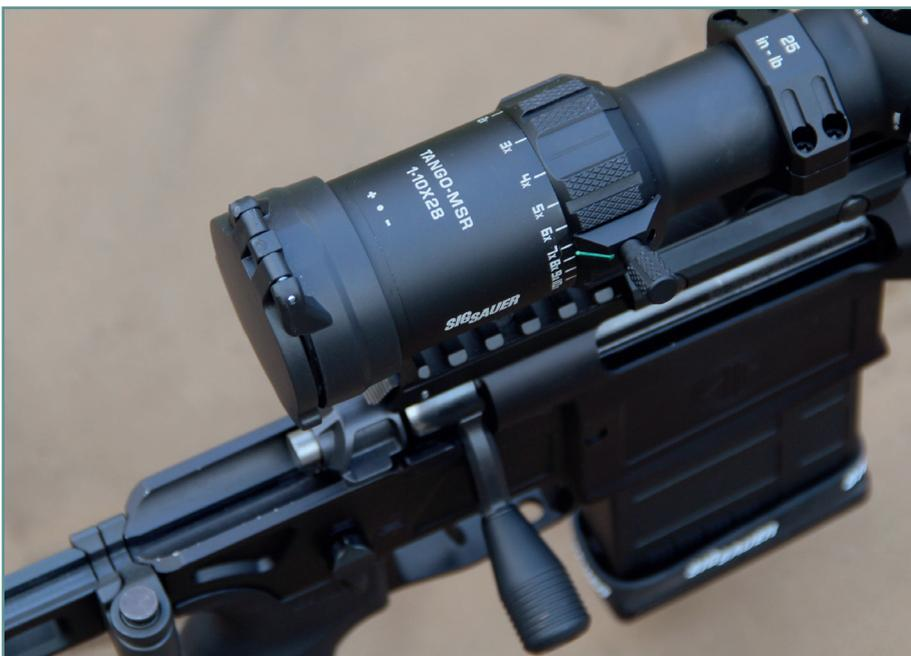
Les tourelles d'élevation et de dérive sont basses. Elles sont équipées d'un capuchon permettant, d'une part de les protéger et, d'autre part, d'éviter une rotation accidentelle des tourelles pouvant causer la perte du zéroage. Une fois les capuchons enlevés, on accède aux tourelles graduées en MOA, chaque clic correspondant à 0,5 MOA, un tour complet de la tourelle de hausse correspond à 50 MOA. La totalité
