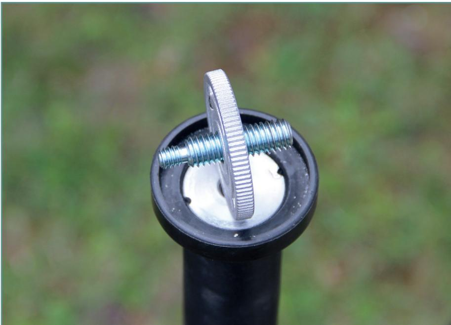
Les pieds en aluminium sont fixés sur le plateau à l'aide de trois vis BTR. Les pieds ont un diamètre de 30 mm pour la plus grande section, de 27 mm pour la deuxième, de 23 mm pour la 3ème section. C'est cette dernière qui supporte les pantins en caoutchouc.
