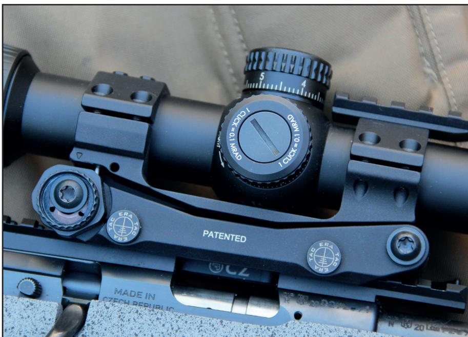
faut lever le bouton de sécurité vers le haut et ensuite tirer le levier vers soi. La mise en place du montage et son réglage sur le rail sont assez simples.
