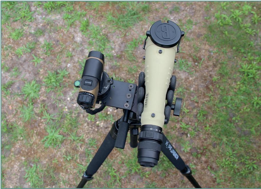
les pieds supérieurs sont équipés de mousse améliorant efficacement la prise en main. La mise en œuvre du trépied est facilitée par les molettes et le levier, ces molettes sont bien adaptées avec l'utilisation de gants.
