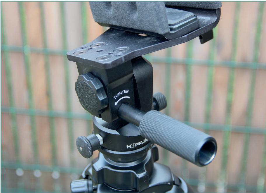
Ce système est intéressant car il permet de limiter l'axe de rotation par tranche de 90°. L'axe d'inclinaison verticale est lui aussi équipé de deux systèmes de verrouillage : une molette placée sur le côté de l'axe assure sa fixation sur le châssis de la rotule, un levier va aider à la manipulation verticale de la rotule sur 109° (21° vers le haut et 87° vers le bas).
