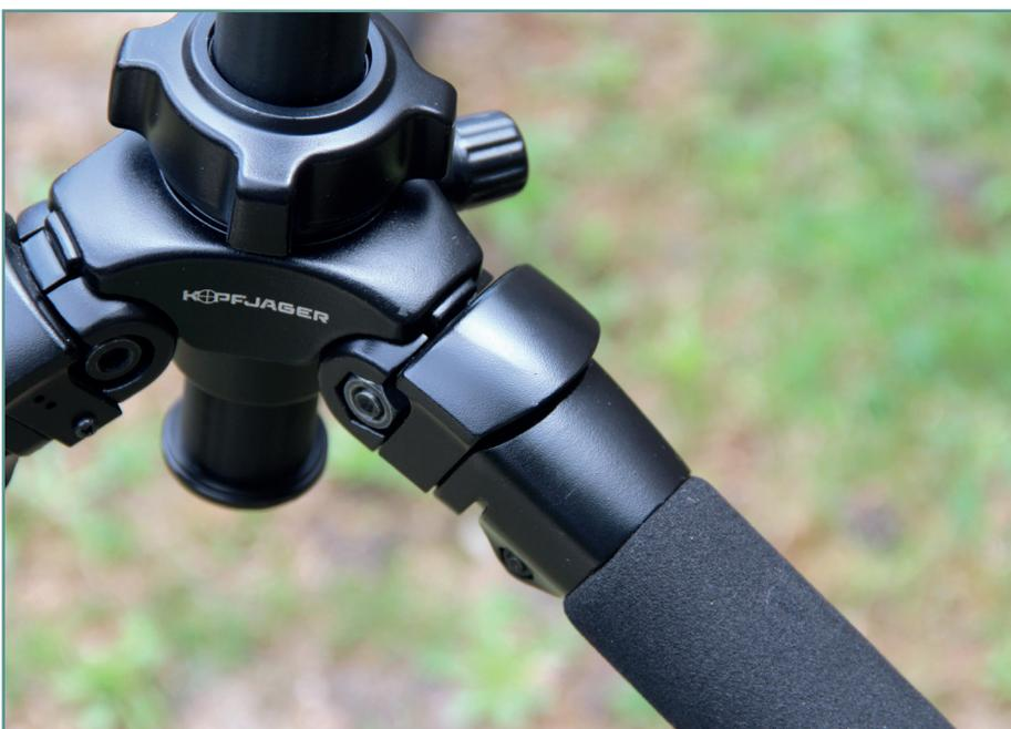
Il est possible de modifier l'angle d'inclinaison des pieds du trépied. Le trépied est ajustable sous trois différents angles. Pour modifier l'angle, il suffit de plier légèrement le pied vers l'intérieur et tirer le verrou se trouvant sur la partie de la section haute du pied au niveau du plateau.
