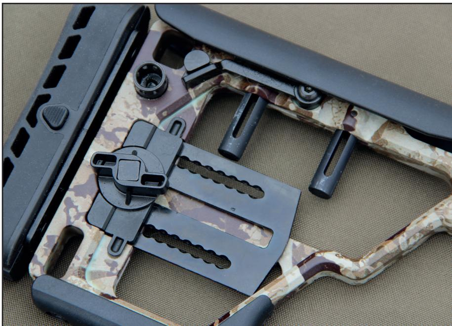
compte de celle-ci avec la main faible pour assurer le verrouillage de la position de tir. La crosse dispose d'un système d'attache de sangles QD réversible.
