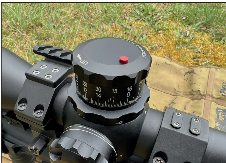
Les deux tambours ont un sens de rotation horaire (CW Clock wise), les directions Up pour le tambour de hausse et R (right) pour le tambour de dérive sont indiquées. Il suffit donc de tourner les tambours dans le sens des aiguilles d'une montre pour gagner en élévation et corriger la dérive vers la droite. Le tambour de dérive bénéficie de marquages supplémentaires sur les deux plages de réglage permettant
