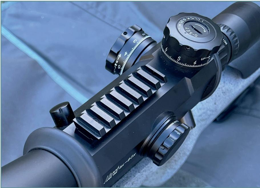
La plage d'élévation (une fois le zéro effectué et le zéro stop actif) est de 2000 clics, c'est juste énorme. Nous n'avons pas pu aller plus loin car à 2000 clics, la lunette touche pratiquement le canon de l'arme. La tourelle d'élévation est équipée d'un zéro stop. Des repères sur le corps interne de la tourelle permettent de savoir combien de tours vous avez réalisés.
