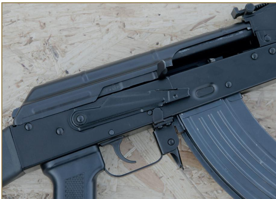
A l'intérieur du bloc inférieur, une fois le capot enlevé, nous accédons à la culasse et au transporteur. Comme sur la majorité des AK, le transporteur supporte le piston et le levier d'armement. Le démontage est aisé, les pièces internes sont de bonne qualité et l'ajustement des pièces est étonnamment précis.
