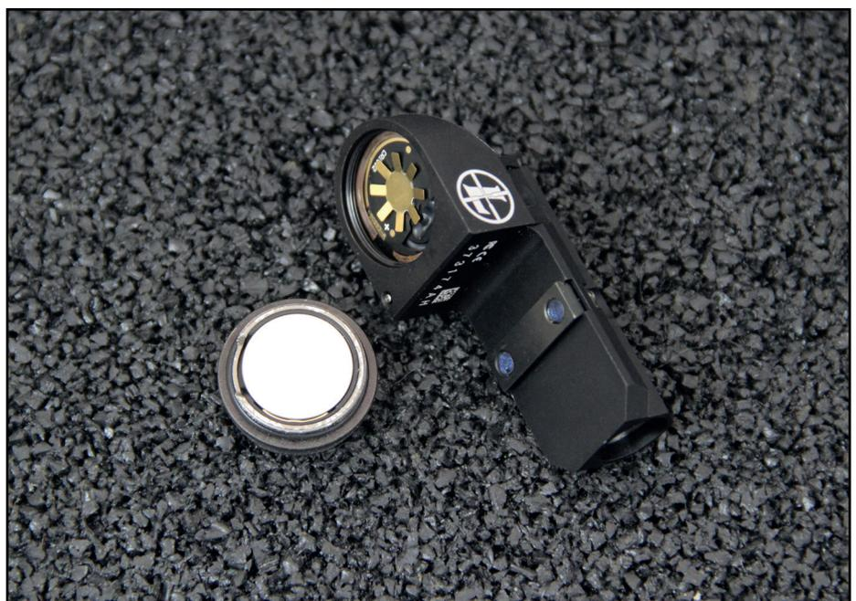
se trouve placé directement sur le capuchon du logement de la pile. Il se visse assez facilement, une lame ressort assure le contact de la batterie avec l'électronique de l'optique. Un joint monté sur le capuchon assure l'étanchéité.
