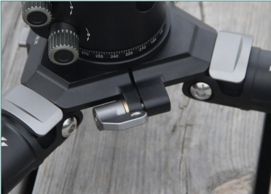
Le second système consiste en un loquet qui permet le serrage du support de la rotule et empêche sa rotation. En effet, le plateau est ouvert ; de ce fait, quand on serre le loquet, on réduit le diamètre du logement ce qui a pour effet de verrouiller le support de la rotule. Ce loquet, quoique petit, permet d'appliquer une force suffisante pour bloquer le support de rotule.
