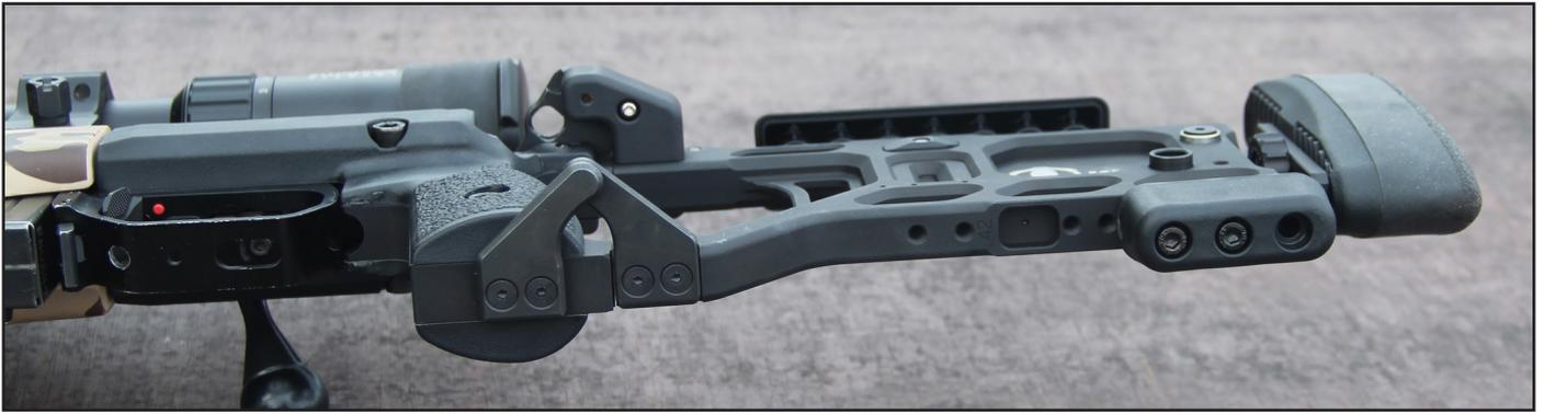
verrouillage est visible lorsque la crosse est sur le côté. Le déverrouillage s'effectue en appuyant sur un petit bouton qui libère la crosse et permet de la verrouiller de nouveau en position d'épauler. Sous la crosse, nous trouvons un patin qui va permettre de positionner un petit sac arrière qui va favoriser la position de tir. Plusieurs trous filetés permettent de le positionner correctement, ces logements peuvent aussi permettre de fixer un rail Picatinny.
