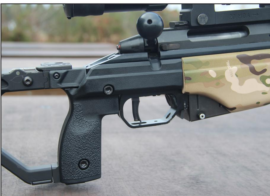
La crosse s'intègre bien sur le châssis ; nous ne constatons pas de jeu entre la crosse et la partie avant du châssis d'origine si ce n'est qu'ils ne sont pas de la même épaisseur. Le logement du levier d'armement tombe au bon endroit et le levier se manœuvre sans forcer. L'insertion et la sortie du chargeur se fait sans problème.
