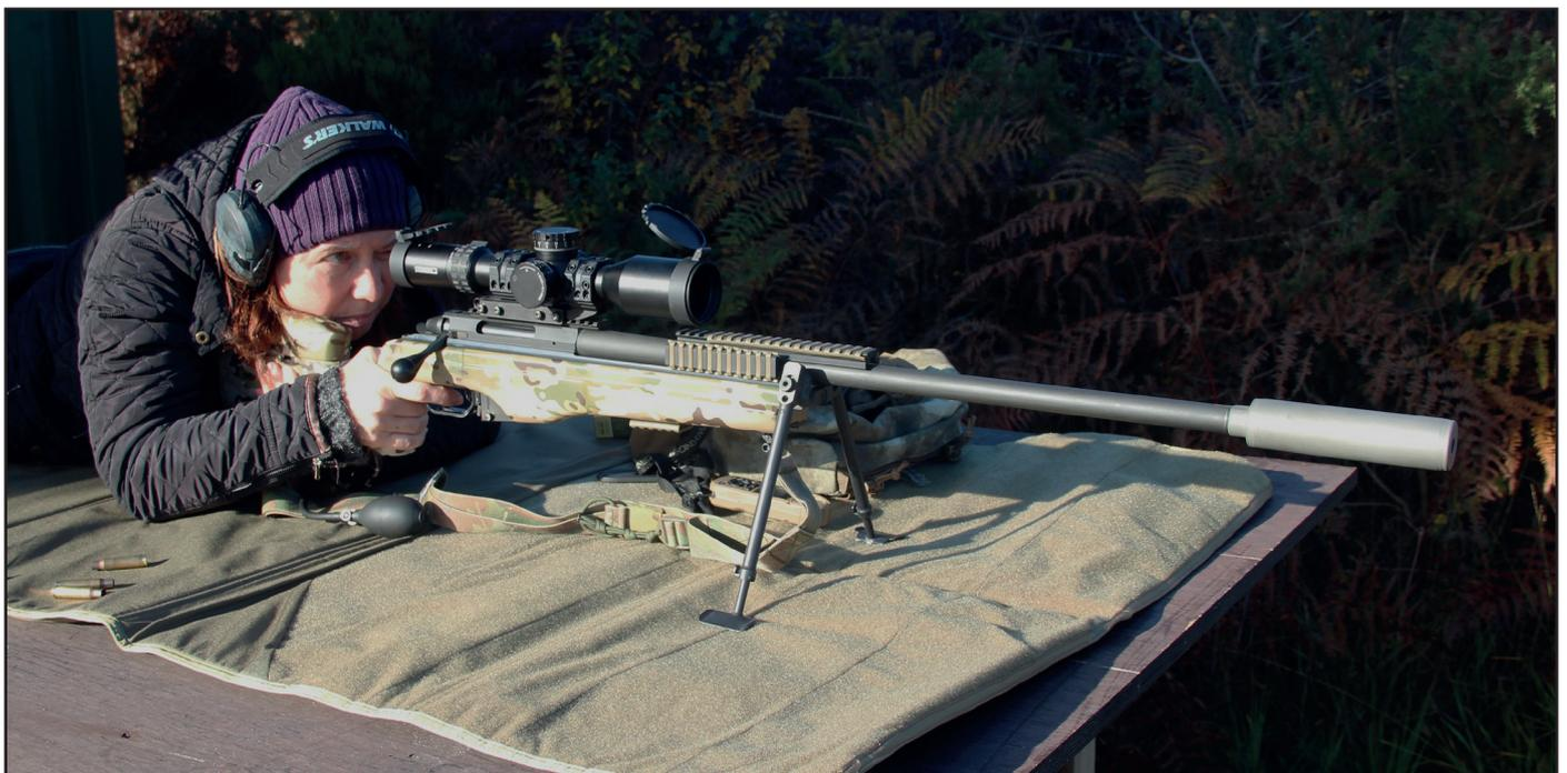
Le MSR2 est optimisé pour le tir à très longue distance. Et pour ce faire, la partie inférieure de 10, 20, 30, 40 Mrad sous le réticule se voit appliquée un copier-coller du réticule central avec son dot, sachant que plus la valeur inférieure augmente, plus les sous-réticules offrent des corrections en dérive importantes. Ces sous-réticules, tous les 10 Mrad, permettent de compenser le nombre de clics quand le tambour de hausse a épuisé les siens.
