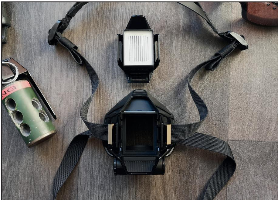
La cartouche filtrante est composée de différentes couches de matériaux agencés en accordéon, ce qui permet d'augmenter la surface de filtration en permettant un plus grand passage d'air, et donc une diminution de la résistance lors de l'inspiration. Cela devient essentiel pour un opérateur lorsqu'un effort physique intense est demandé et que de grandes inspirations deviennent donc nécessaires.
