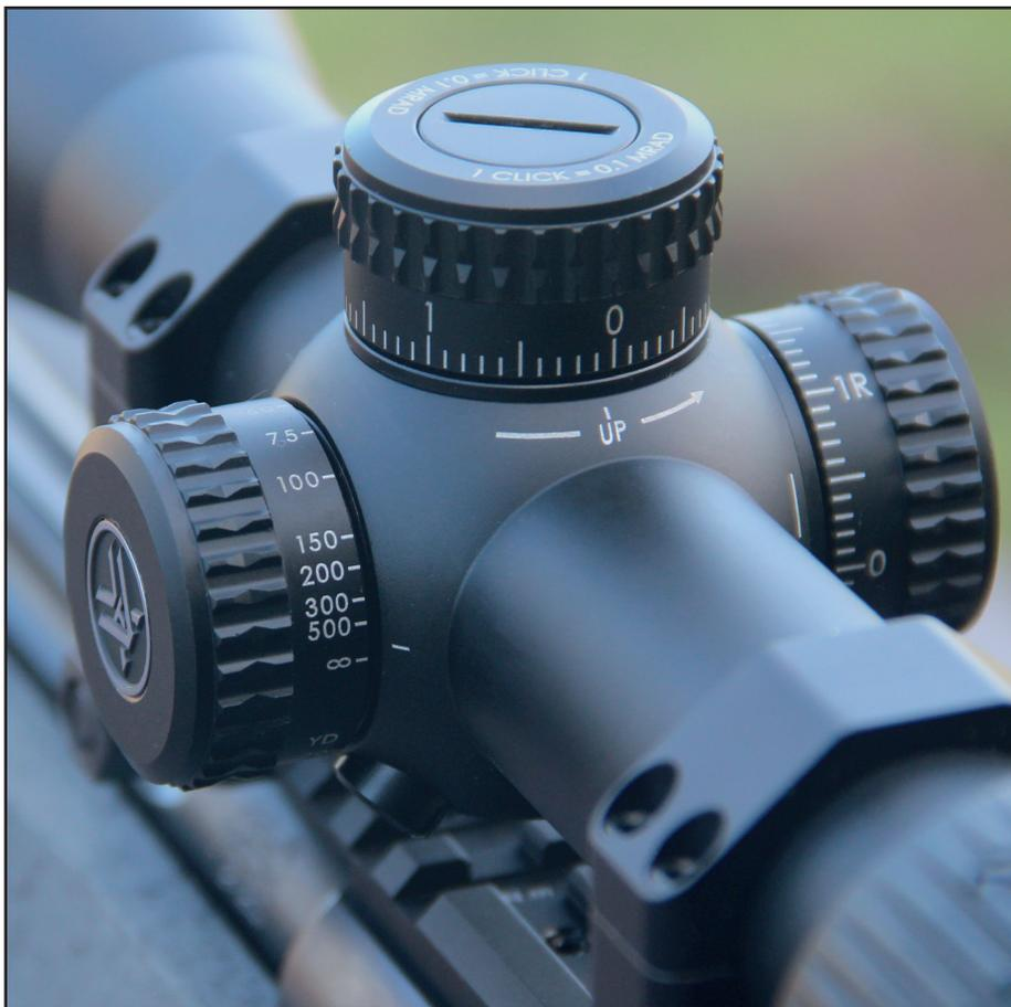
La prise en main est facilitée par un moletage de la partie haute de la tourelle. La lunette est en Mrad, chaque clic correspondant à 0,1 mil (1cm à 100m). La plage d'élévation (une fois le zéroage effectué sur un rail penté à 25 MOA) est comprise entre - 167 et + 122 clics.
