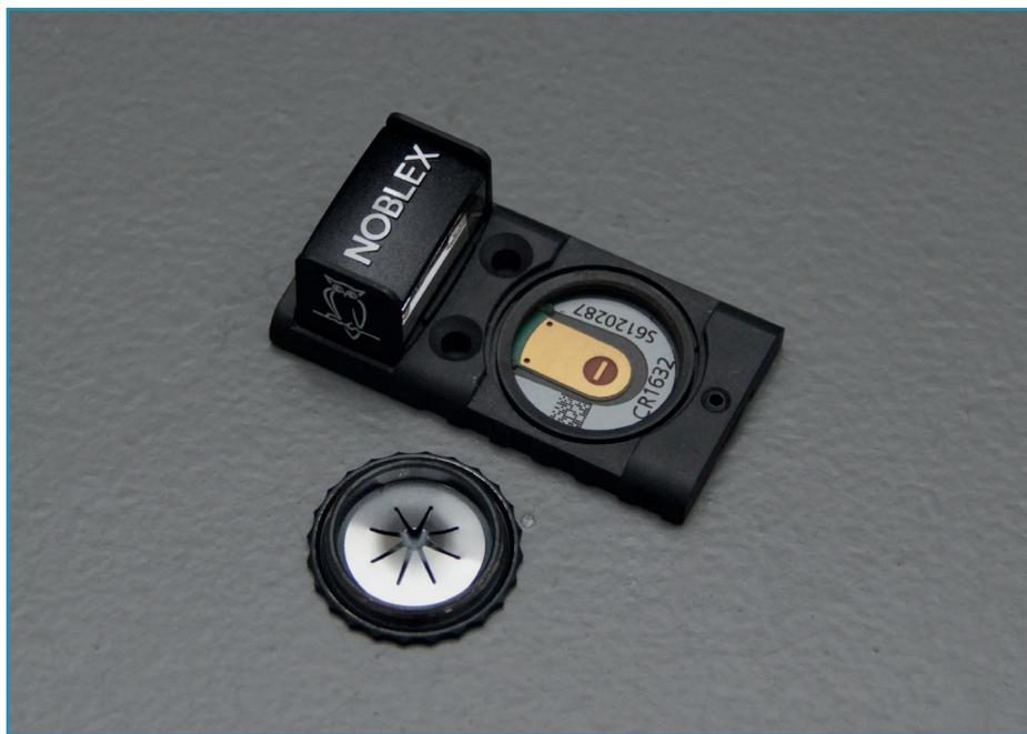
et se visse assez facilement, une lame ressort assure le contact de la batterie avec l'électronique de l'optique. Par contre, nous constatons l'absence de joint d'étanchéité, que ce soit sur la capot ou dans le logement de la batterie. Le verrouillage du capot se fait en force avec les doigts. A l'arrière du corps de l'optique, nous trouvons trois vis BTR, une sur le dessus et deux sur les côtés. Ces vis vont permettre de régler l'optique en cible.
