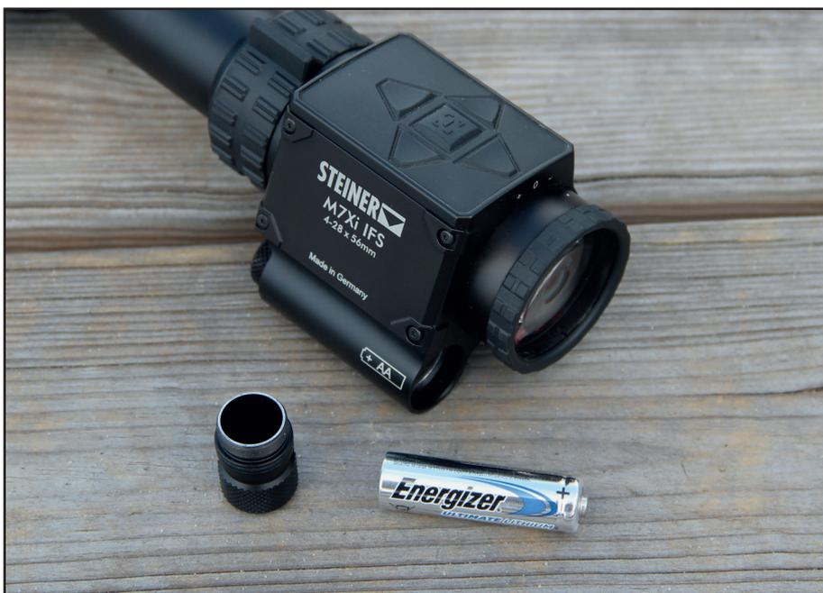
Plusieurs capteurs sont intégrés dans le boîtier afin de fournir au logiciel balistique des données permettant de trouver une solution de tir. Ces capteurs mesurent la température, la pression atmosphérique, l'inclinaison de l'arme et son devers et la dérive induite par ce paramètre. Le logiciel balistique quant à lui, va fournir une solution de tir en associant ces informations aux caractéristiques de la munition précédemment donnée par le tireur.
