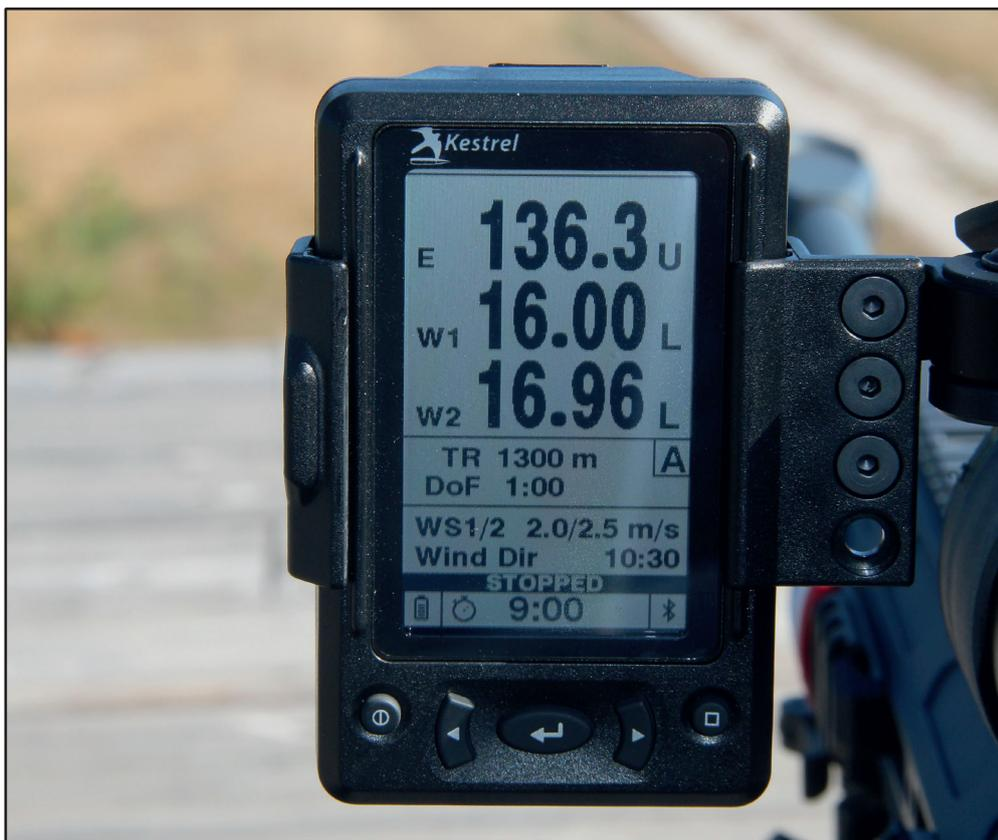
suffit d'appuyer sur les boutons de navigation gauche/droite (au choix) et de laisser le doigt dessus pour voir défiler les distances mètre par mètre. Une fois la distance choisie, le HUD transmet l'info au Kestrel qui va appliquer une nouvelle solution de tir qui s'affichera en même temps sur l'anémomètre et le HUD.
