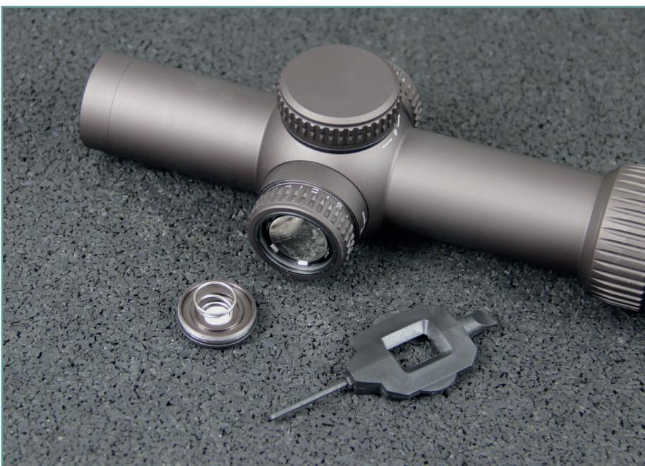
éclairage. Au milieu de la tourelle, nous trouvons un bouchon fermant hermétiquement le logement de la pile CR2032 servant à l'illumination du dot. Deux piles sont présentes dans la boîte de l'optique.
