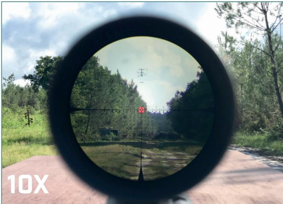
se trouvant entre 0 et 50m sans aucun problème. Le défaut de parallaxe au-delà de 20 mètres est à peine perceptible dans ce grossissement. La recherche de la distance oculaire lors de la prise de visée est pratiquement imperceptible. Le réticule est quasiment invisible, seuls les trois traits d'une épaisseur de 0.15 Mil apparaissent sans gêner la prise de visée.
