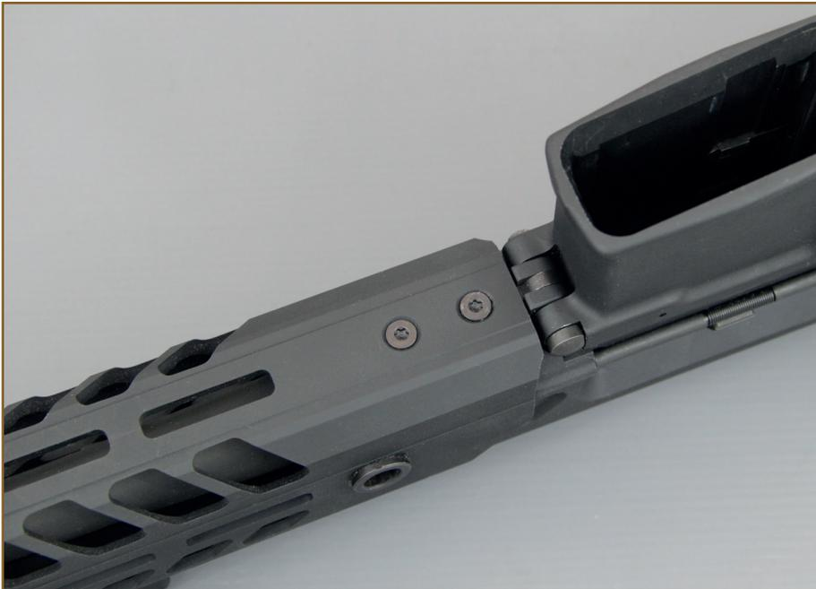
Une pièce en forme d'anneau est fixée à l'arrière du garde-main. Cet anneau, une fois le rail bloqué dans le Upper, va venir se placer dans l'axe du logement de la goupille avant, fixant le Upper au Lower. Une fois la goupille enfoncée, le garde-main est verrouillé.
