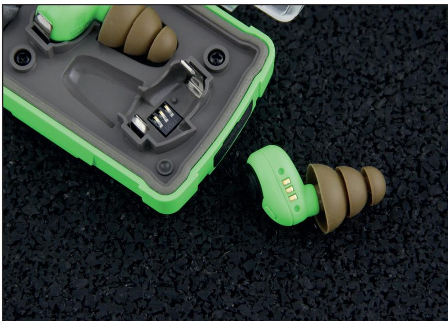
prise et connecté au secteur, soit directement au secteur à l'aide d'une prise compatible, celle de votre téléphone par exemple. Le temps de charge est relativement long, nous l'avons mesuré à 180 minutes. Mais la durée des batteries avoisine les 16 heures d'autonomie.
