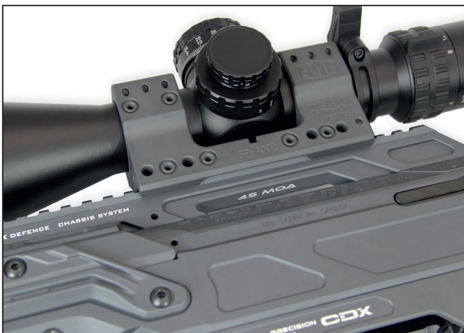
Un rail supérieur court sur toute la longueur du châssis. Ce rail Picatinny est en deux parties, chacune étant usinée dans un seul bloc. Sur le PATRIOT ce rail peut être incliné à 20, 30, 45 Moa en fonction du désir des clients. Le rail est penté sur toute la longueur afin de conserver l'alignement entre une optique jour et un accessoire optique complémentaire, ou un système de vision nocturne.
