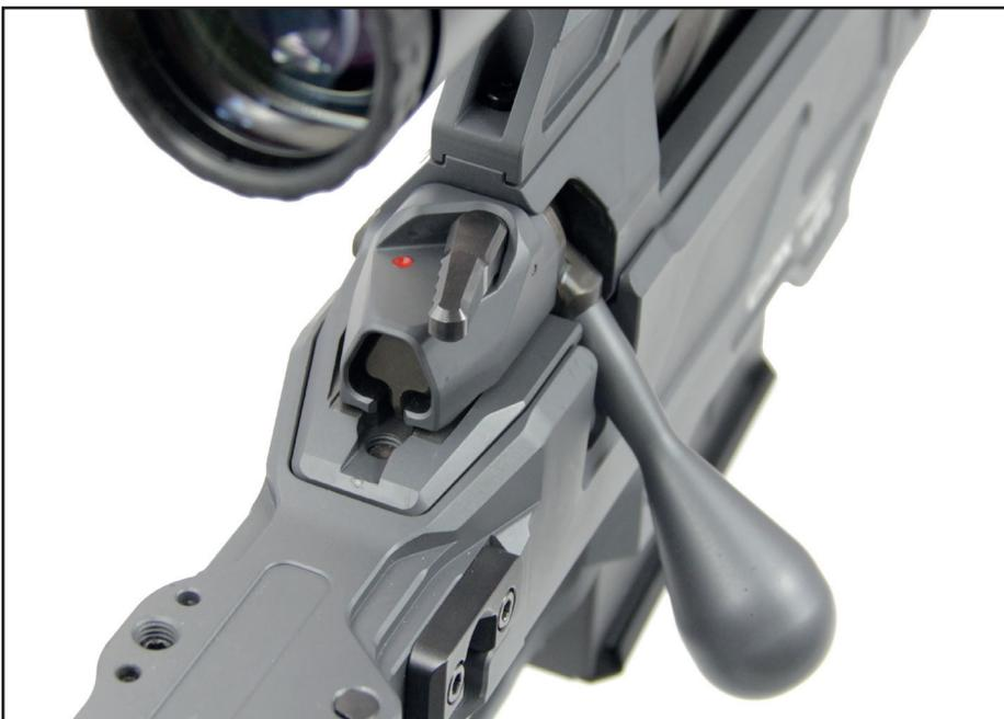
rouge (levier à droite) est visible, la sûreté est enlevée, lorsque l'on aperçoit le point vert (levier à gauche), la sûreté est engagée. La sûreté ne peut être mise en œuvre que quand la culasse est verrouillée et il est impossible une fois la sûreté engagée de manipuler la culasse.
