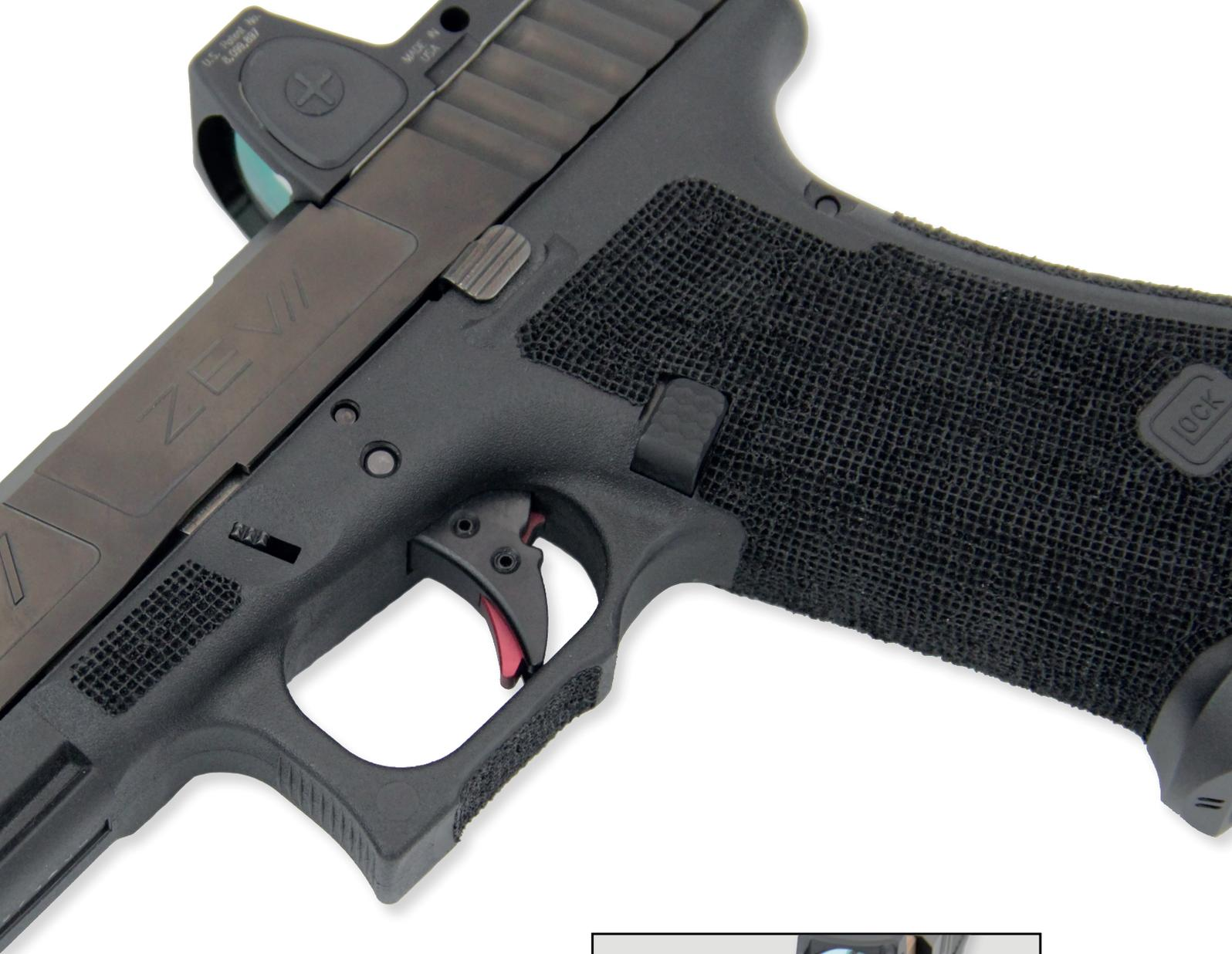
Ces modifications réalisées, ZEV a ajouté des accessoires : par exemple, un poussoir de chargeur rallongé en aluminium aéronautique et anodisé. Ce poussoir offre une très bonne assistance au déverrouillage du chargeur et, de par sa forme, il ne provoque pas de libération accidentelle du chargeur s'il se trouve être pressé par la main.
