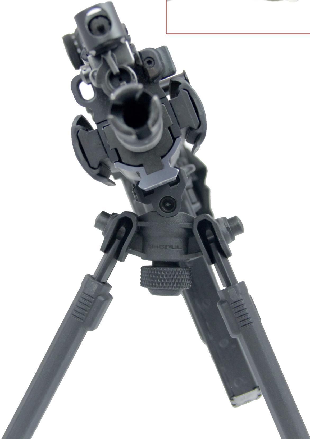
Une autre option est possible sur le bipied : une fois la molette de déverrouillage entièrement dévissée, on peut faire faire un demi-tour au montage du bipied afin d'accéder au contrôle de l'angle de direction. Le débattement de cet angle est de 40°, il permet par exemple de suivre une cible mobile.
