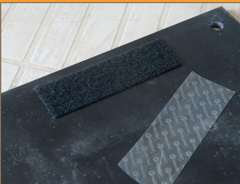
trouver le bon espacement, il suffit d'utiliser l'épaisseur du réflecteur comme gabarit avant de coller la bande Velcro®. Suivant le type de cible ou de support, il faudra positionner la bande Velcro® soit horizontalement soit verticalement. Pour un montage horizontal, il est souhaitable de mettre le T1000 sur le haut de la cible.
