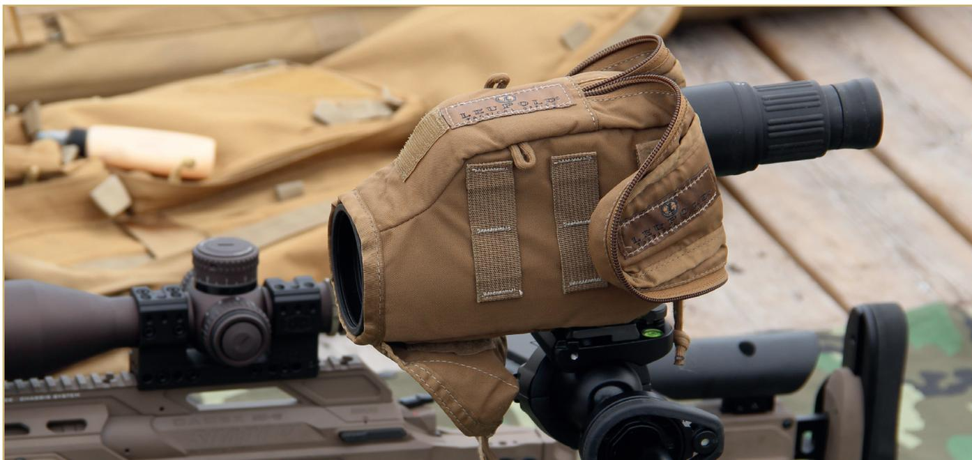
dépasse les 1000m. En effet, le grossissement de la lunette de tir ainsi que le diamètre de l'optique, ne sont plus forcément adaptés à la pratique de l'observation des impacts. La solution va consister à s'équiper d'une lunette d'observation plus performante et dédiée au travail du spotter.
