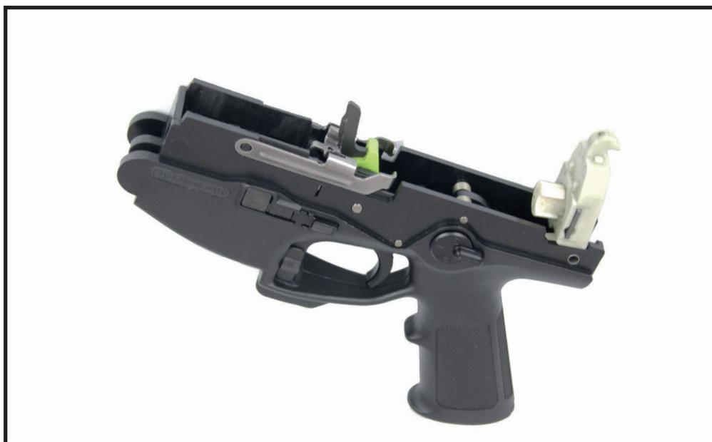
Le système est entièrement démontable afin de faciliter le nettoyage. L'anneau de la sangle monté sur celle de l'ARX 160 disparaît et permet de monter un levier plus grand, donc plus facile à manipuler.
