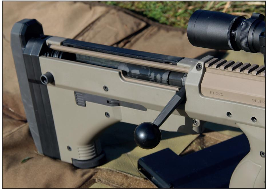
la partie du logement qui permet de faire glisser la culasse afin de la verrouiller ou la déverrouiller, la chambre est donc bien plus en avant de la crosse. A l'arrière de l'appui joue, nous trouvons une plaque de couche qu'il est possible d'ajuster en hauteur et en longueur en ajoutant un insert. La plaque de couche se démonte
