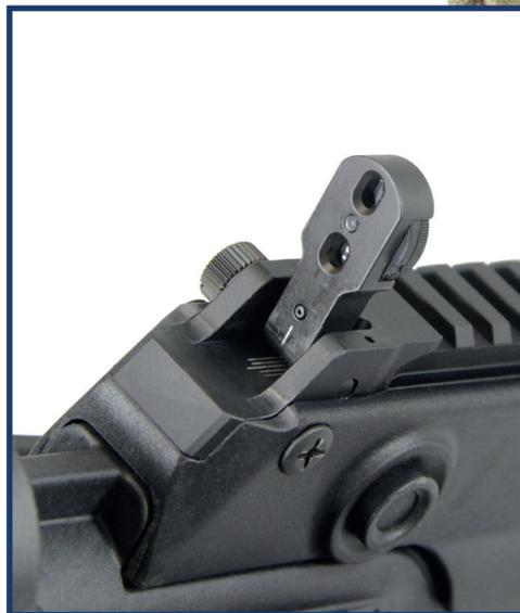
Le garde main supérieur reçoit le levier d'armement ambidextre, une poignée de portage, un rail NAR (STANAG 4694) au-dessus de l'ensemble et des éléments de visée mécanique. Contrairement au VHS-D2 où les éléments de visée mécanique sont indépendants et montés sur le rail NAR, elles sont intégrées directement dans le rail sur le VHS-F2. L'œilleton est réglable en direction (1 clic = 1.3 cm à 100m) et il est équipé d'une hausse. Le guidon se règle quant à lui en hauteur (1 clic = 1.5 cm à 100m)
