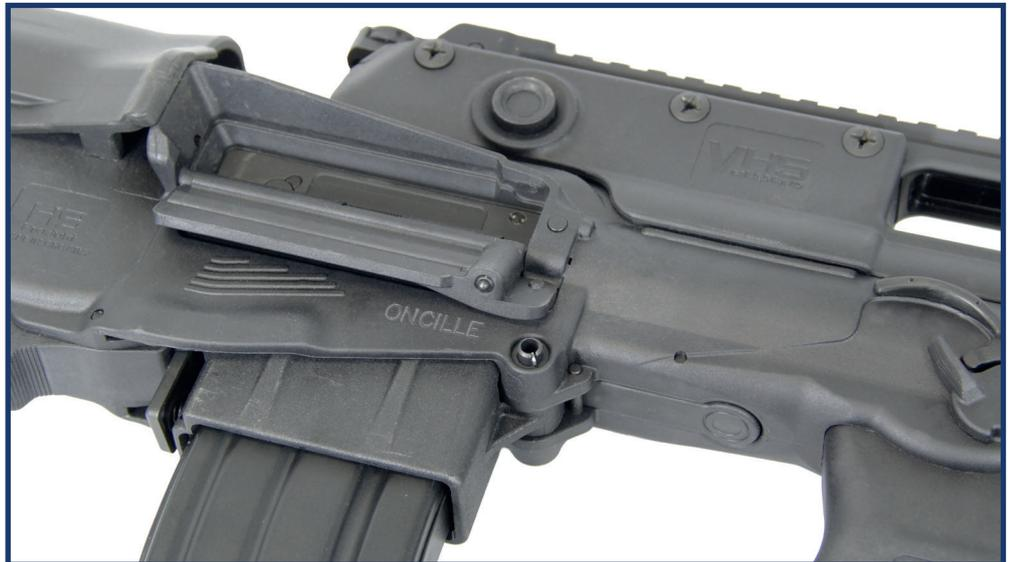
Le bloc mécanisme qui fait office de pièce de sécurité est fabriqué en acier sur le VHS-F2 alors qu'il est en polymère sur la version de base du VHS-D2. Deux puits de chargeurs amovibles : le premier puits de chargeur peut recevoir les chargeurs en plastique translucide de chez HS Produkt. Le second puits de chargeur permet d'utiliser les chargeurs de 20 et 30 cartouches répondant au STANAG 4179 de l'OTAN. (SCAR, HK416, ARX160 et SIG MCX). C'est ce dernier qui est monté sur le VHS-F2.
