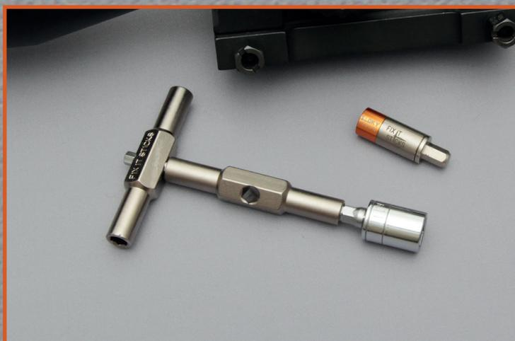
Les limiteurs de couple se fixent directement sur les tiges métalliques Fix It Sticks, il suffit ensuite de fixer sur la clé l'embout correspondant à votre besoin. Lors du serrage une fois le couple atteint, le limiteur se débraye automatiquement. Ce débrayage est annoncé par une série de clics audibles.
