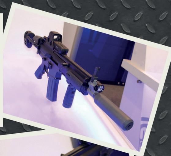
FNH présentait le SCAR-P® en calibre 5.56x45. Disponible avec trois types de crosse : fixe, pliable ou télescopique (version présentée). Il est équipé d'un atténuateur de son fixé à demeure sur le canon. Le levier d'armement est monté du côté droit de l'arme, il n'est pas réversible. Les éléments de visée sont plus sommaires que sur la version SCAR-L®. Encore en développement, cette carabine est adaptée à un besoin spécifique des Forces de l'Ordre.
